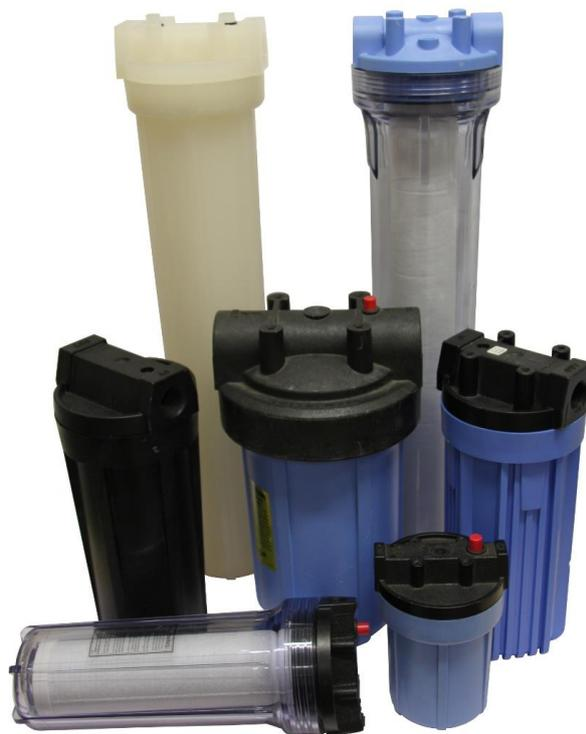
In allen Gehäuseausführungen werden Filterelemente mit einem Außendurchmesser von 60 bis 70 mm verwendet. Eine Ausnahme bilden die Gehäuse des Typs Big Blue (BB). Dort werden Filterelemente mit einem Außendurchmesser von 115 mm eingesetzt.
